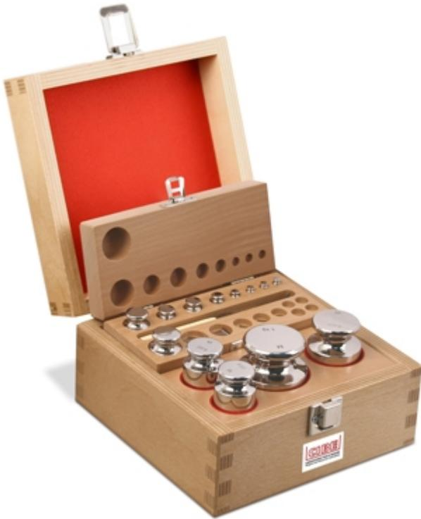
Série de poids en bois avec poids en acier inoxydable, conformes à la recommandation OIML-R111 en classe M1, adaptés aux applications de métrologie légale et au secteur industriel. La classe de précision M1 permet l'utilisation de ces poids pour le contrôle et l'étalonnage des balances et des instruments de mesure de la classe III, jusqu'à 10.000e.
